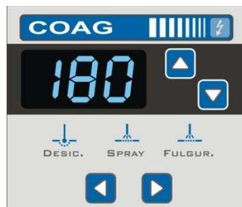
A função Coagulação (COAG) está dividida em DESICCATE, SPRAY e FULGURATE. A troca de uma ação para outra é feita através das teclas “deslocamento para a esquerda <|” ou “deslocamento para a direita |>”, na cor azul. A informação de que a seleção foi aceita é indicada pela respectiva função acesa.
