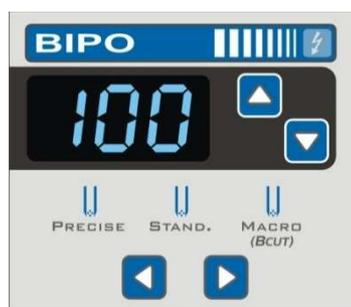
A função BIPOLAR foi dividida em PRECISE, STANDARD e MACRO. Ao selecionar uma das funções do BIPOLAR, observe que o CORTE (CUT) e a COAGULAÇÃO (COAG) serão desativados (os displays correspondentes são apagados). Apenas os dígitos indicativos da potência BIPOLAR estarão visíveis.
