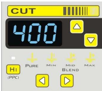
A função Corte (CUT) (região amarela) está dividida em dois tipos: CORTE PURE (liso, pouca fulguração e com pouca hemostasia) e BLEND, com as opções BLEND1(MIN), BLEND2(MID) e BLEND3(MAX). A opção Corte/Blend permite uma mistura de corte com coagulação. A hemostasia é pequena na escolha Blend1(MIN) e maior se a escolha for Blend3(MAX).
