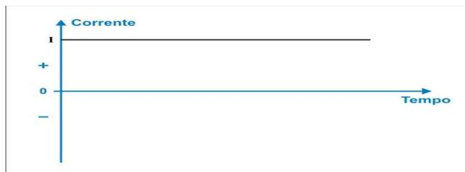
Figura 1. Corrente Contínua (C.C.) ou unidirecional. A corrente flui em um único sentido, do pólo positivo para o negativo (sentido convencional). Pode haver variação de amplitude, porém não de sentido.
